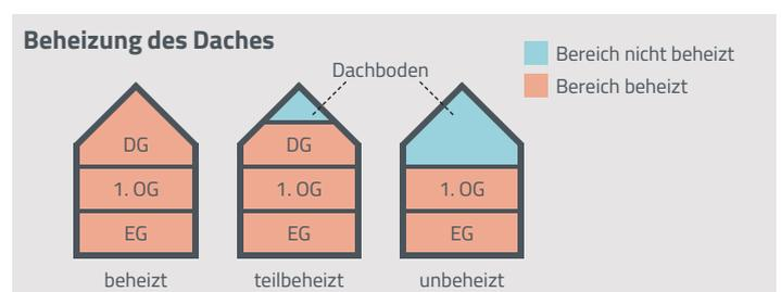
Teilbeheizte Dächer besitzen über dem beheizten Dachgeschoss zum Beispiel einen unbeheizten Dachboden, Speicherkammer oder ähnliches.
